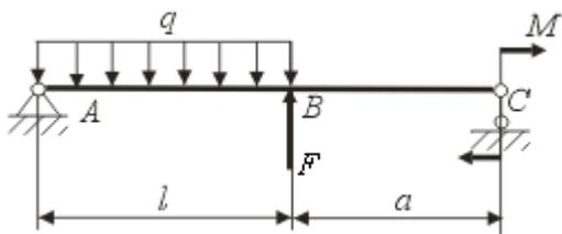
Определить размеры поперечного сечения балки из условия прочности по нормальным напряжениям.
